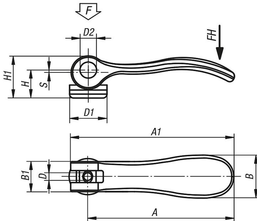
**Exzenterhebel / Griffhebel / Kipphebel mit Innengewinde**
