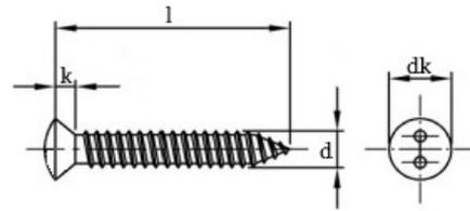
Linsenkopf Sicherheits Blechschrauben mit Zweiloch-Antrieb
