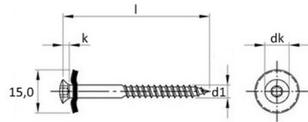
**Spenglerschrauben 2tlg. mit Dichtscheibe 15 mm und TX Antrieb**
