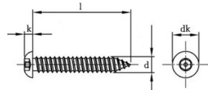
**Linsenkopf Sicherheits Blechschrauben mit ISK und PIN**
