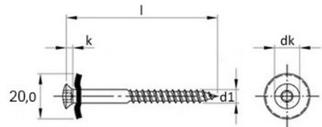
**Spenglerschrauben 3tlg. mit Dichtscheibe 20 mm und TX Antrieb**
