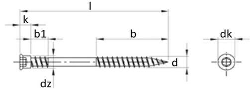
Terrassenbauschrauben Zyl.-Kopf mit Untergewinde
