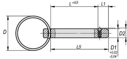
Bolzen: Stahl verzinkt / Schlüsselring: Edelstahl
