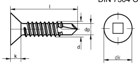
Bohrschauben mit Senkkopf und V Antrieb
