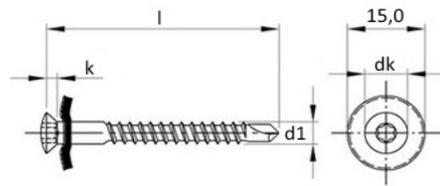
**Spenglerschrauben 2tlg. mit Dichtscheibe 15 mm, TX Antrieb und Bohrspitze**
