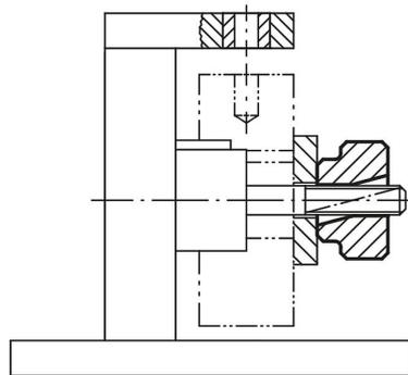
X: Der Gewindebolzen sollte einige mm länger sein als die Höhe „H“
